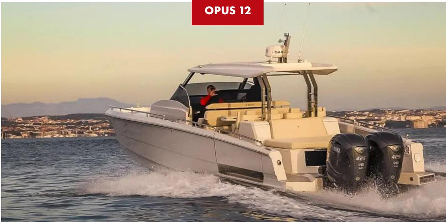
**Opus 12, luksuzni tender za mega jahte domaćeg proizvođača Opus Boats, imat će sajamsku premijeru na ovogodišnjem Biograd Boat Showu. Opus 12 je dug 12,3 m, širok 3,5 m te teži oko šest tona, a pokreću ga dva vanbrodska motora Yamaha V8s od 425 KS. Maksimalna brzina mu je 53 čvorova, dok pri brzini od 40 čvorova troši samo tri litre goriva, tako da nijedno odredište nije predaleko. Ova kombinacija pruža vrhunske performanse, brzinu i rukovanje.**
